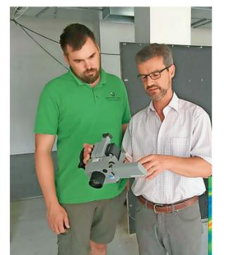
Das Auffinden von nicht sichtbaren Heizungsleitungen in Betondecken war das Ziel der Messungen, die von der Fa. Allgeyr und dem TCW durchgeführt wurden. Foto: Fa. Allgeyr
